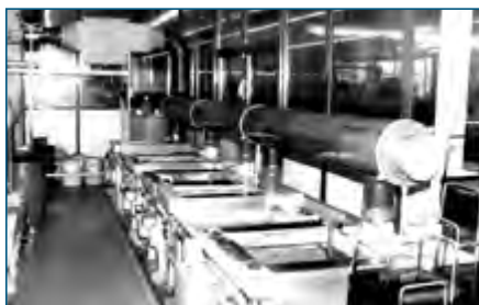
Abwasserlose Brünieranlage Гальваническое производство с замкнутым циклом.
