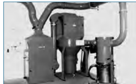
Absauganlage für Schleifstäube Вентиляционные установки для вытяжки абразивной пыли
